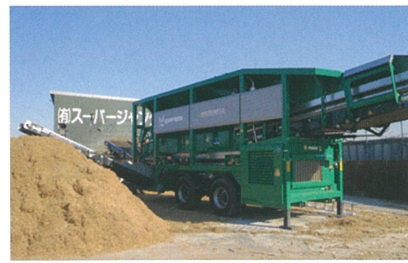
緑産 マルチスター 選別機 (Mul-1) (スタースクリーン) L3L 最大処理量:300m³/h(使用するスターセグメントにより相違) 作業内容:混合物の選別
