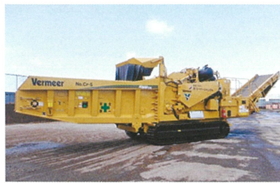
バーミア 自走式木質系破碎機 (Cr-5) (ホリゾンタルグラインダー) HG6000TX 処理能力:487.2t/日(8時間) 作業内容:木くず破碎
