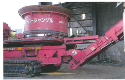
バーミア 自走式木質系破碎機 (Cr-3) (タブグラインダー) TG540TX 処理能力:361t/日(8時間) 作業内容:木くず破碎
